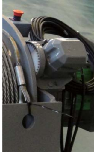
Limit switch «Trolley out» and «Trolley in»
